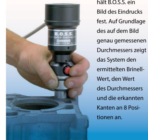
hält B.O.S.S. ein Bild des Eindrucks fest. Auf Grundlage des auf dem Bild genau gemessenen Durchmessers zeigt das System den ermittelten Brinell-Wert, den Wert des Durchmessers und die erkannten Kanten an 8 Positionen an.
