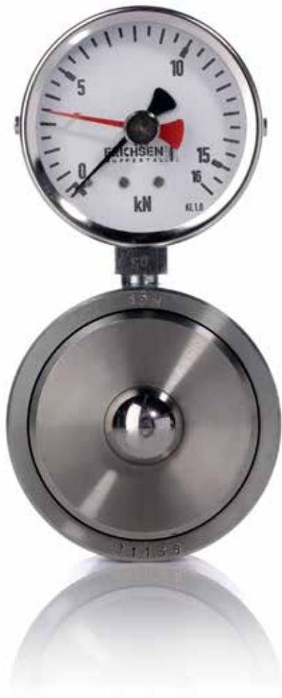
Der Kraftmesser Modell 338 ist sowohl für gelegentliche Kontrollmessungen als auch für den permanenten Einbau konzipiert. Die robuste Bauweise lässt den Einsatz auch im rauen Betrieb an Maschinen und Vorrichtungen zu. Das Standard-Anzeigegerät mit 63 mm ø ist mit Schleppzeiger ausgerüstet.
